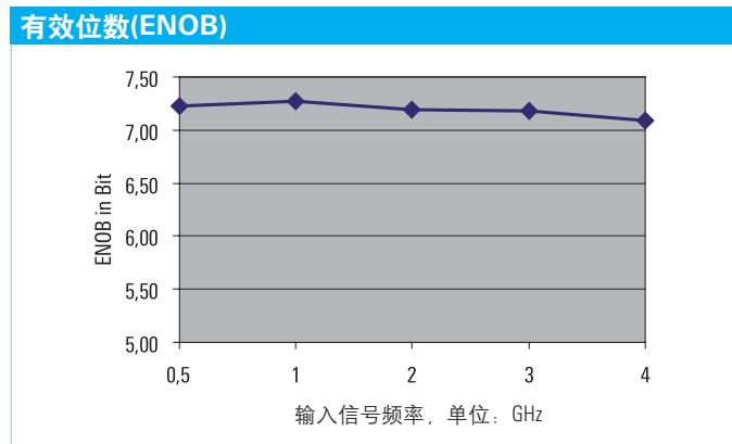
R&S®RTO 示波器始终使用高有效位数 (ENOB) 的模数转换器，确保可以准确的描述信号细节，并具备极大的动态范围。
