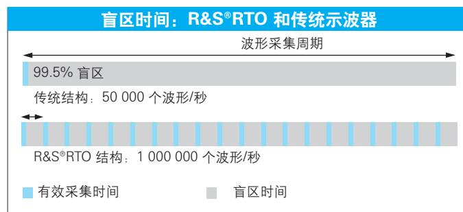
R&S®RTO示波器的盲区时间极短，其采样测量信号的频率要高出20倍以上
