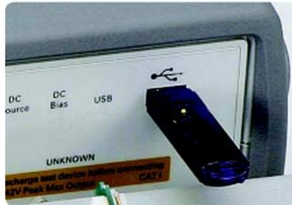
图 9. E4981A 支持使用 USB 存储器
