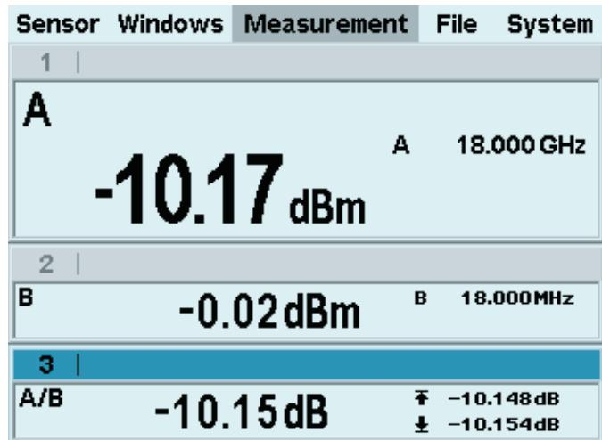
使用R&S®NRP-Z81宽带功率探头的时间门功能确定EDGE一个突发的功率，排除信号中心的训练序列
