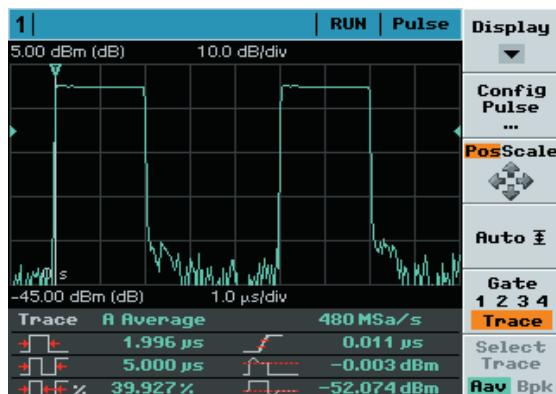
连接R&S®NRP-Zxx功率探头的R&S®NRP2功率计
