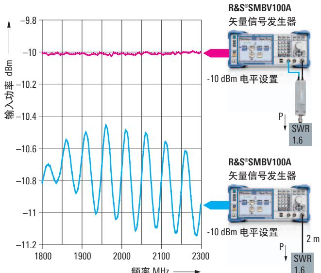
使用R&S®NRP-Z28/-Z98电平控制探头，持续监控信号发生器输出功率和自动电平校正
